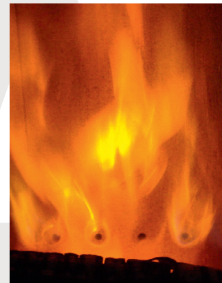
Tertiärluft wird durch Düsen im hinteren Brennraumbereich „eingeblassen“
